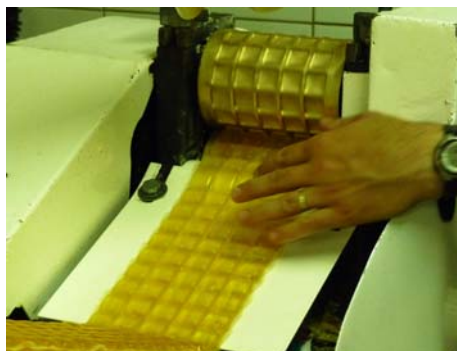
La préparation est à nouveau chauffée pour la ramollir et permettre ainsi le moulage. Les bergamotes finissent ensuite doucement de refroidir.
